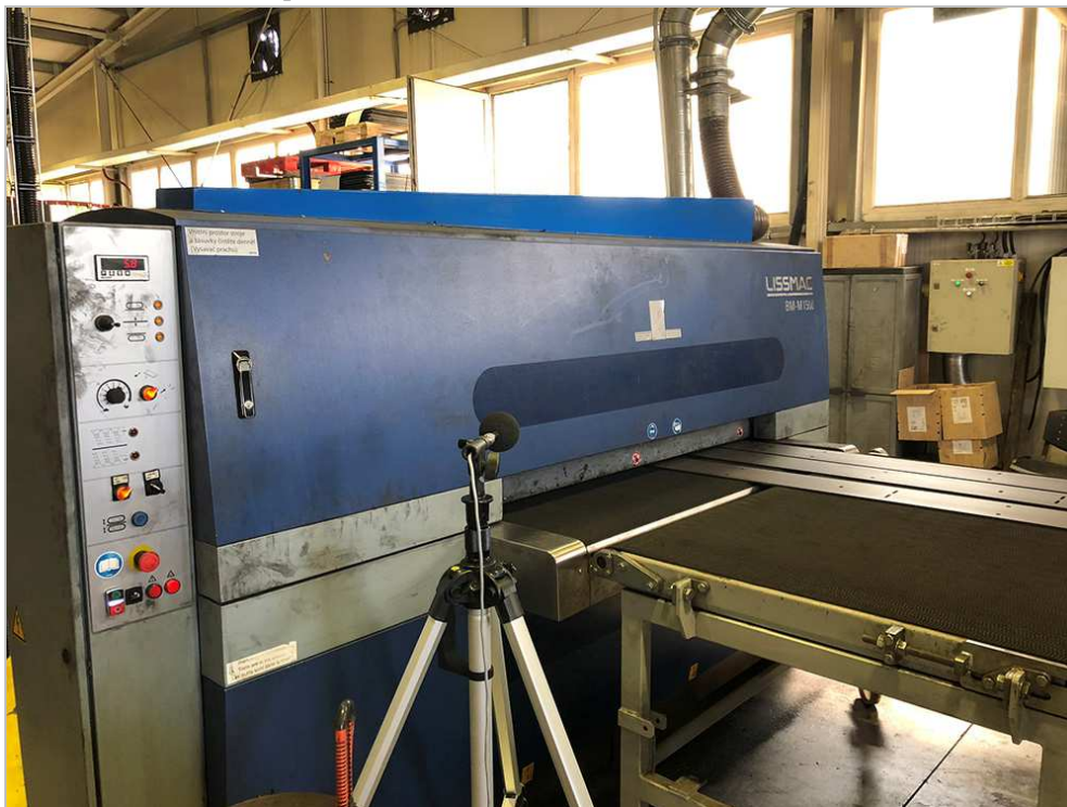
Obr. 36: LISSMAC SBM-M1500 – proces kartáčování
